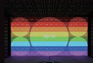
横8m×縦4mのLEDウォールを完備。ピッチ2.3mmのバーチャルプロダクション用LEDビジョンを使用し、横3,456×縦1,728pxの解像度で表示可能です。
